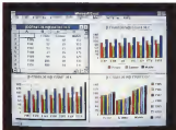
Figure 1 - Business Graphics - Concetto di Serie. Sia che si lavori con uno spreadsheet sia che si lavori con un prodotto di tipo Graph, la produzione di un qualsiasi Diagramma parte da una o più serie di dati numerici disponibili in forma tabellare. Se la tabella è rettangolare, ed ha dimensioni di righe e di colonne, occorre decidere se si lavora con Serie organizzate per righe o per colonne. Nella figura vediamo chiaramente i rapporti con gli stessi dati messi nelle due diverse
